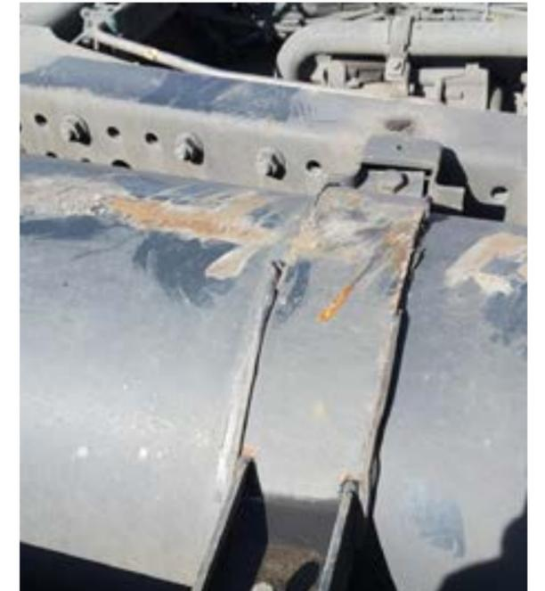
Rost, Dellen, Bruchschäden und/oder Riefen → Berechnung des Austauschs von Halterungen und Haltebändern.
