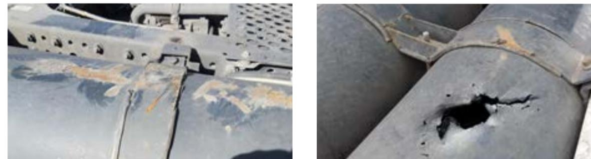
Offensichtliche Reparaturen an der CNG-Flasche → Berechnung des Austauschs der CNG-Flasche.
