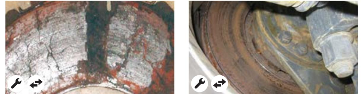
Verrostete, nachgeschliffene, abgenutzte Brems Scheiben
