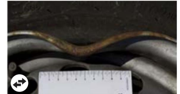
Felgenhorn beschädigt, Felge nicht eingetrag. Durchführung einer Maßprüfung zur Überprüfung des sicheren Zustandes des Fahrzeugs
