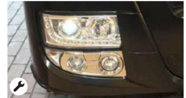
Leichte Kratzer (ohne Materialabtrag), außerhalb des Ausleuchtfeldes und des Glühbirnengehäuses (POLIEREN)
